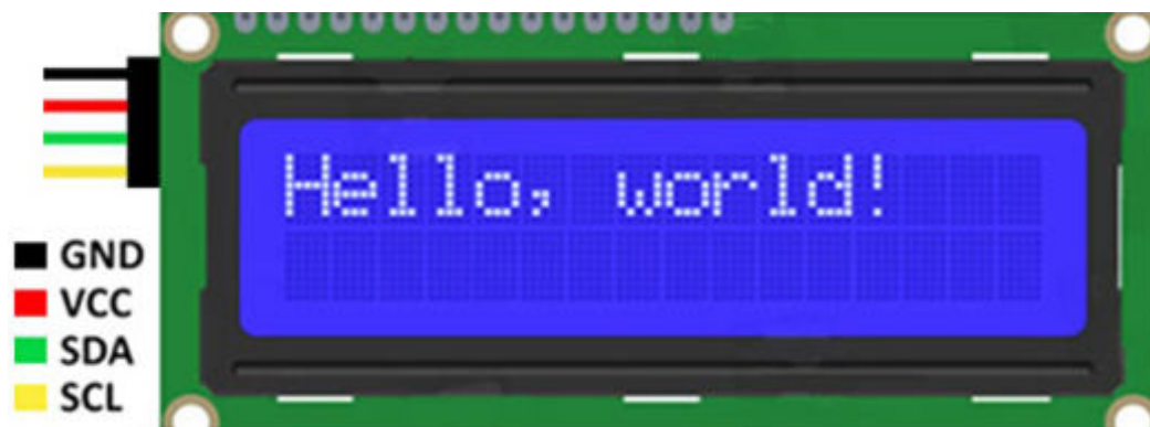
Рис. 1. Подключение модуля ЖКИ к Ардуино
