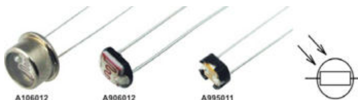
Рис. 12. Фоторезисторы и их обозначение
