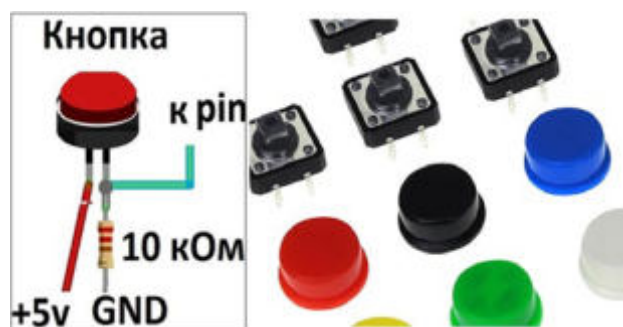
Рис. 1. Схема подключения тактовой кнопки к микроконтроллерной плате
